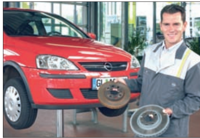
Die Folgen der Dauerbelastung sind einer stark beanspruchten Bremsscheibe (links) im Vergleich mit einer neuen deutlich anzusehen. Foto: Opel/GP
