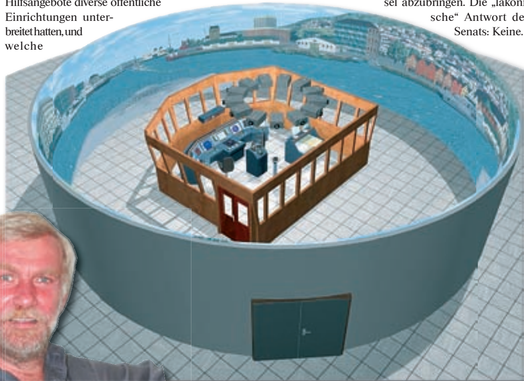
Der 360 Grad-Schiffssimulator mit 14 Metern Durchmesser und einer Rundumsicht ist das Herzstück des MTC. Leider nicht in Harburg.
