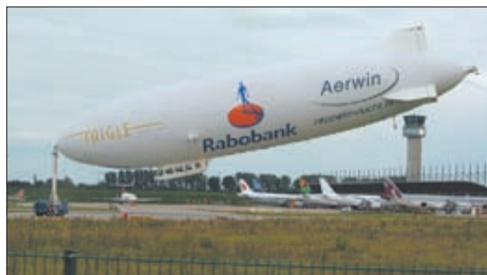
Der Zeppelin macht über der Landebahn an einem „Landeturm“ fest, der auf einem LKW fest verankert ist. Foto: Müntz
