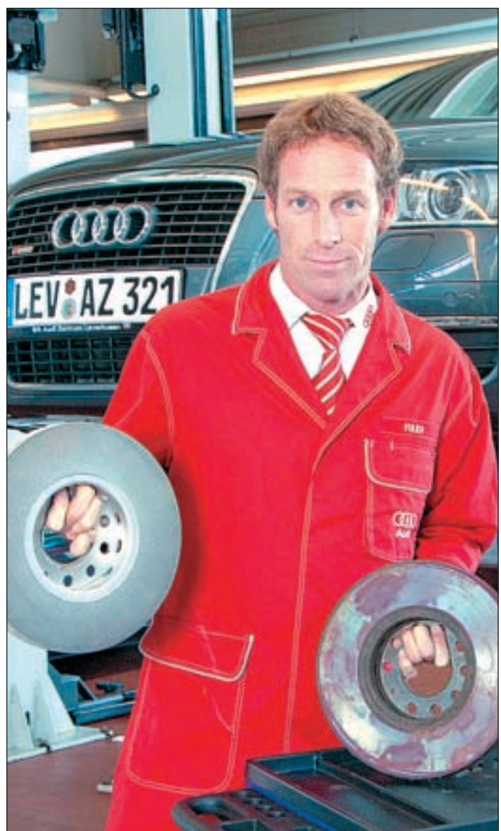
Eine abgenutzte Bremsscheibe kann nicht mehr für einen reibungslosen Bremsvorgang sorgen und stellt somit eine Gefahr im Straßenverkehr dar. Foto: Audi/GP
