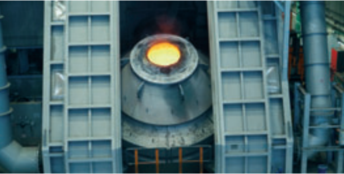
Das Herzstück ist ein speziell entwickelter Konverter, der die eingesetzten Elemente voneinander trennt. Das Aggregat verarbeitet Chargen von etwa 45 Tonnen Gewicht, bei Temperaturen von bis zu 1400 Grad Celsius
